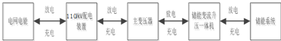
图 4.6 储能电站运营期工艺流程图
